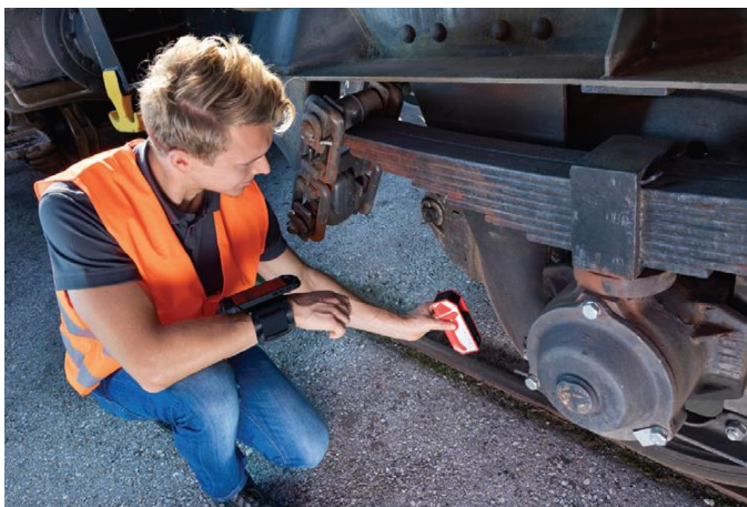
Рисунок 1.1 – Бесконтактное измерение прибором Calipri Prime
