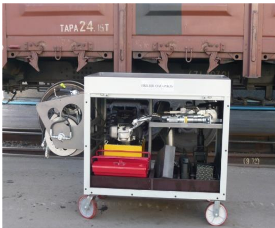
Рисунок 1.9 – Мобильный пост гидрофицированного инструмента
